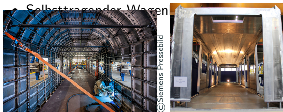
© Siemens Pressebild © Siemens Pressebild Differenzial- (oben) und Integralbauweise
