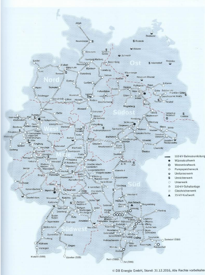
1.3.1 Übersichtsplan der Bahnstromleitungen
