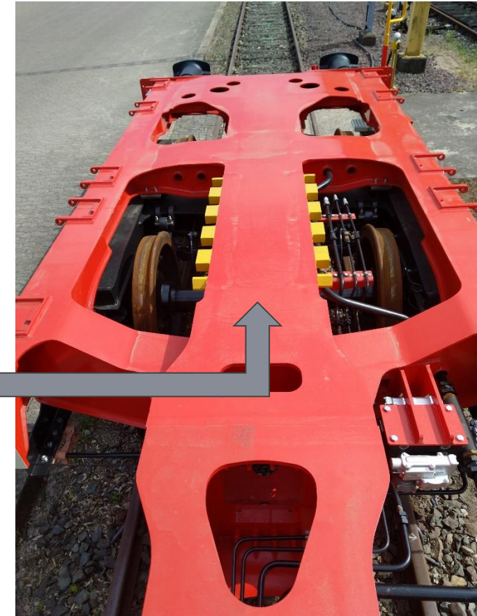
(F1-) Schnittstelle zur Gewährleistung des uneingeschränkten Ablaufbergbetriebes
