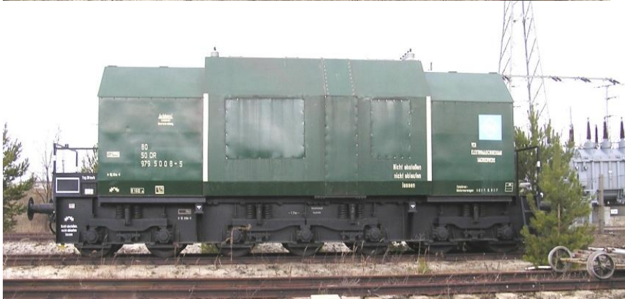
Fahrbare Sy-Sy-Umformer dezentraler Umformerwerke
