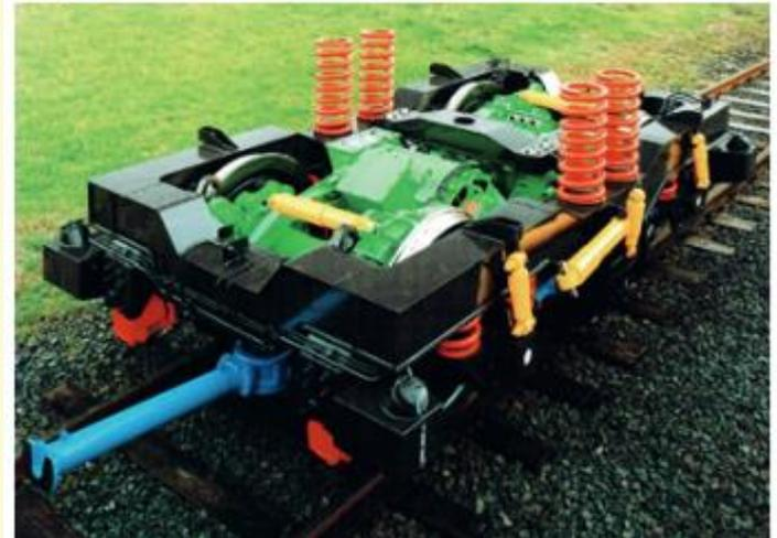
Bild: Beispiel für eine Zugkrafttiefanlenkung gemäß Pkt. 2b mit Zugstange
